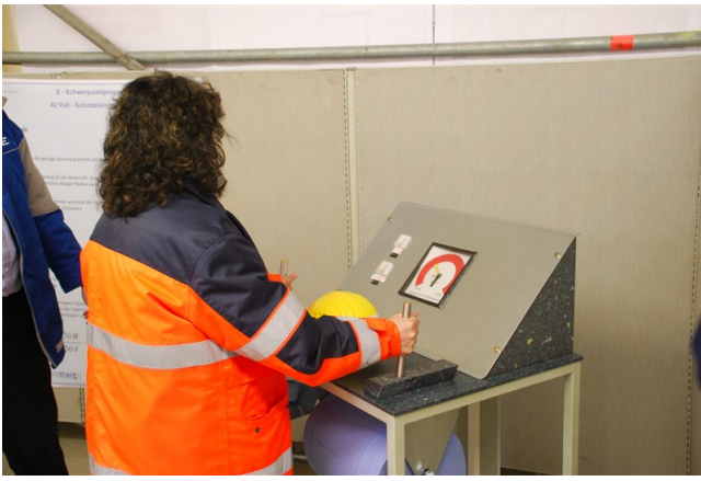
Modell zur Messung des eigenen ohmischen Widerstandes
