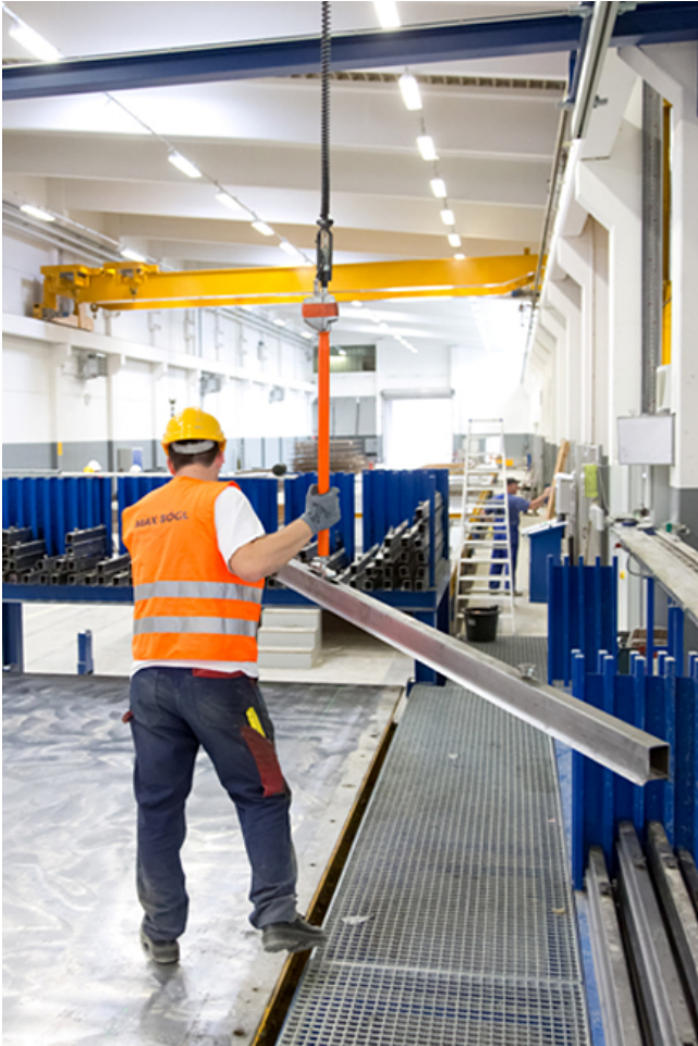
Einschalbereich: Positionierung von 3,30 m langen U-Schalungen mit integrierten Haftmagneten (Masse ca. 22,5 kg) mittels Manipulator
