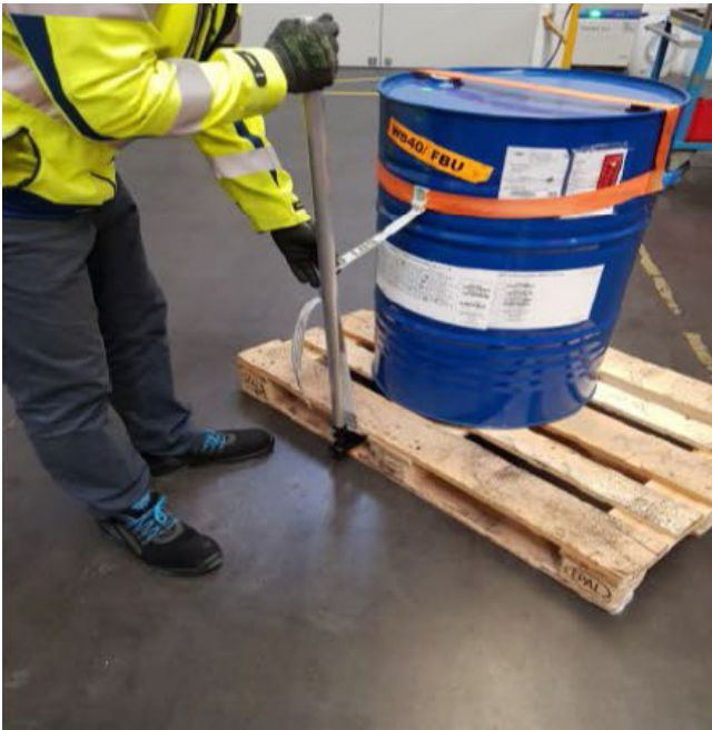
Der Haken wird mit Hilfe der Einfädelhilfe unter die Palette geführt und in der Palette eingehakt
